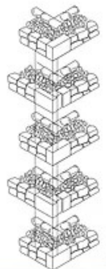
ASSONOMETRIA CANTONALE I primi corsi presenti nel cantonale sono costituiti dalla sovrapposizione di conci in basalto in modo da garantire una maggiore resistenza alle sollecitazioni meccaniche e agli urti
