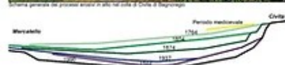
Profili schematici indicativi dell'evoluzione della sella dal XVII secolo ad oggi (CIVITA DI BAGNOREGIO Osservazioni geologiche e sismiche - ENEA Viterbo Lazio Stone)
